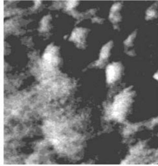
照片4 自然金{110}晶面的STM图像.PtIr 针尖恒流模式扫描,Vb=33 mV,It=1 nA 100 nm×100 nm
