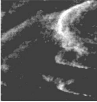
照片3 自然金{110}晶面的STM图像.PtIr 针尖恒流模式扫描,Vb=55 mV,It=1.7 nA 40 nm×40 nm
