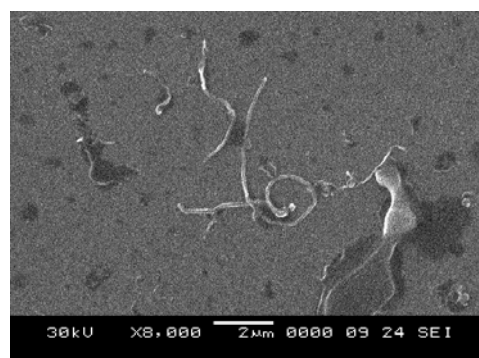
图 7 浓度为 0.12g/L 的 Fc-134 和 0.08g/L 的十二烷基苯磺酸钠作为分散剂的碳纳米管
